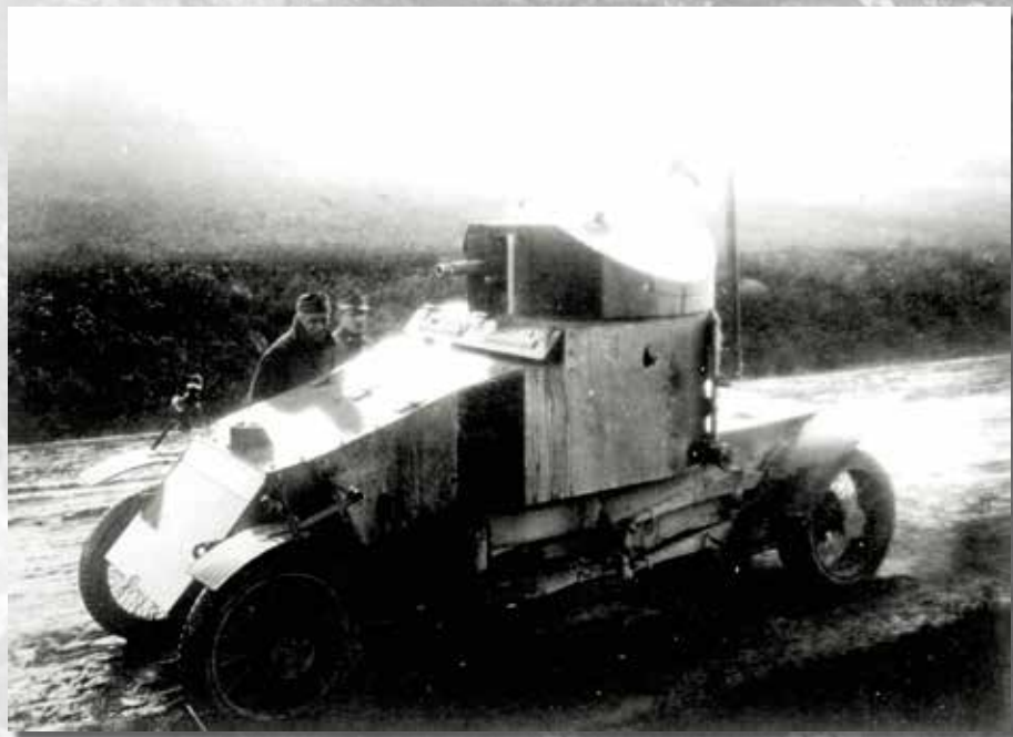
Rakousko-uhersští důstojníci si prohlížejí obrněný automobil Lanchester, opuštěný po ústupu ruské armády od Zborova
