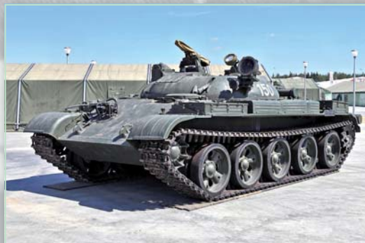
Sovětský raketový tank IT-1, u něhož bylo dělo nahrazeno odpalovacím zařízením řízených střel
