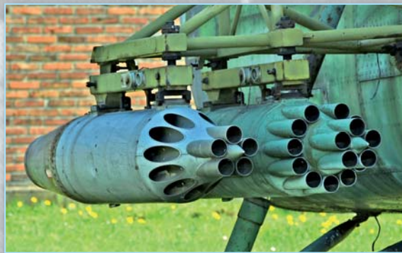
Raketnice UB-16-57UM a UB-16-57KV, každá pro 16 neřízených raket S-5, na vrtulníku MiL Mi-4
