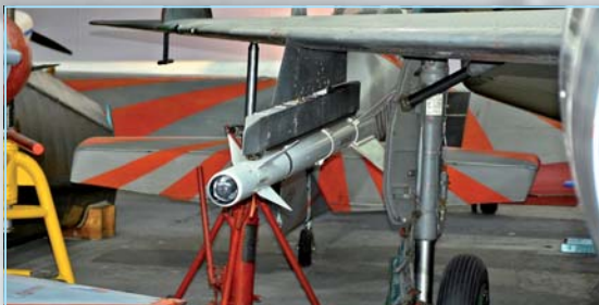
Tepelně naváděná sovětská protiletadlová raketa K-13 (AA-2 Atoll) na letounu MiG-21F. Rakety podobné americkým AIM-9 Sidewinder se v čs. letectvu používaly od šedesátých let
