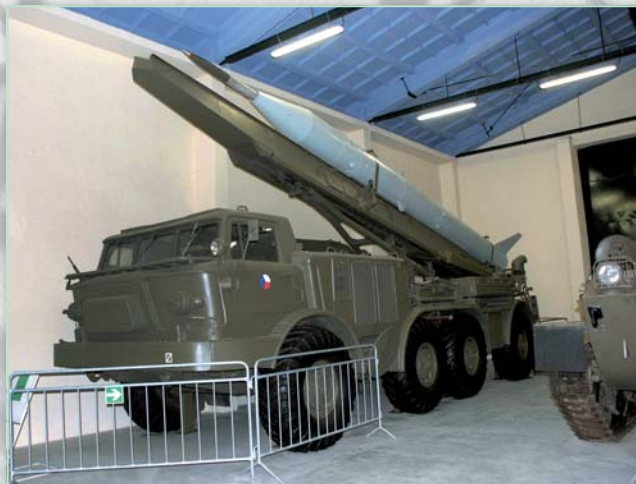
3R-11 Luna M (FROG 7) s cvičnou hlavicí a kolovým podvozkem ZIL-135 (9P113) v Lešanech
