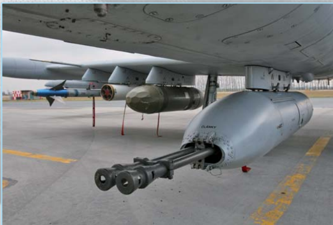
Pohled na mohutnou podvěšenou výzbroj letounu L-159 Alca českého vojenského letectva: dvouhlavňový kanon PL-20 Plamen ráže 20 mm, devatenáctihlavňový raketomet LAU-5003, šestihlavňový raketomet LAU-5002 (oba pro odpalování neřízených raket CRV-7 ráže 2,75 palce) a řízená střela AIM-9M Sidewinder
