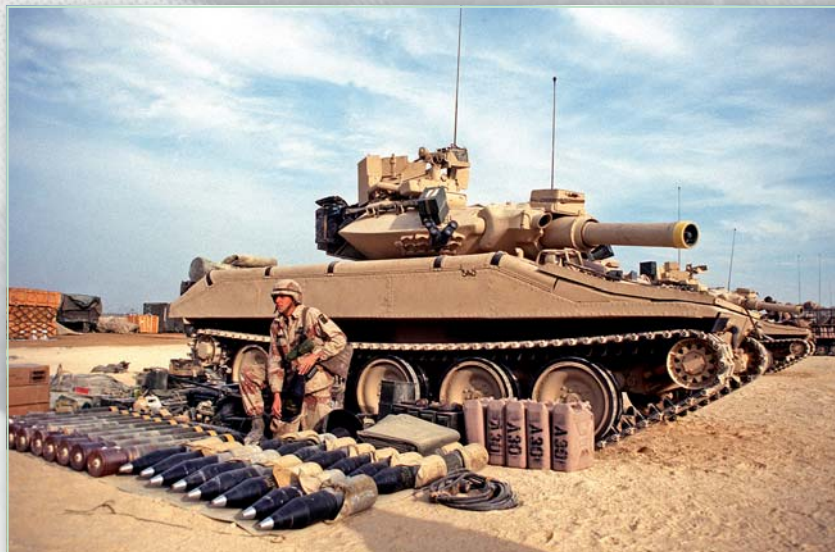
Americký výsadkový tank Sheridan mohl z kanonu vypálit i řízenou protitankovou střelu Shillelagh ráže 152 milimetrů
