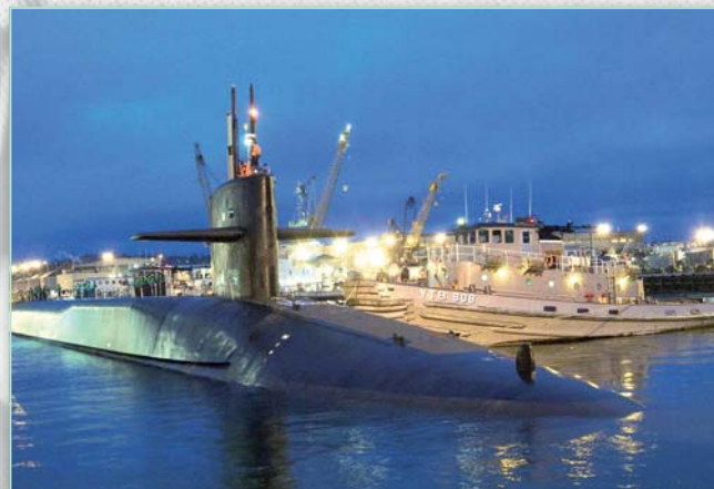
Americká raketonosná ponorka se sadou odpalovacích sil, umístěných v trupu za bojovou věží
