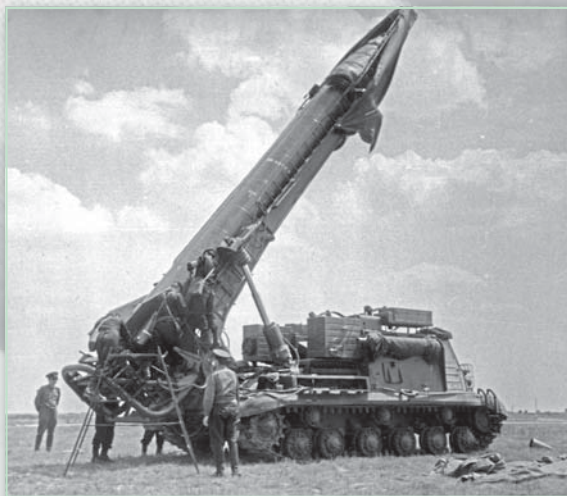
Střelby 311. těžké dělostřelecké brigády v SSSR v červnu 1969. Raketa 8K11 na odpalovacím zařízení 8U218
