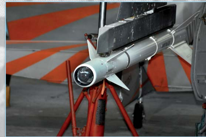
Tepelně naváděná sovětská protiletectvá raketa K-13 (AA-2 Atoll) na letounu MiG-21F. Rakety podobné americkým AIMK-9 Sidewinder se v čs. letectvu používaly od šedesátých let
