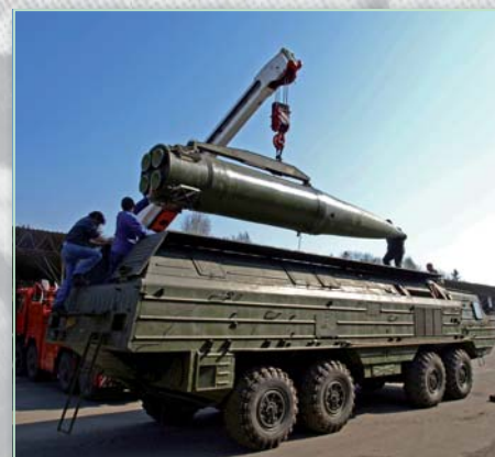
Nakládání rakety 9M714K na mobilní odpalovací zařízení BAZ-6944 kompletu OTR-23 Oka
