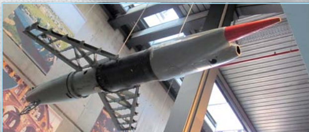
Jedna z prvních řízených protiletadlových střel Hs 117 Schmetterling pocházela z druhé světové války a mohla startovat z pozemní rampy nebo z palub těžkých stíhačů nacistické Luftwaffe
