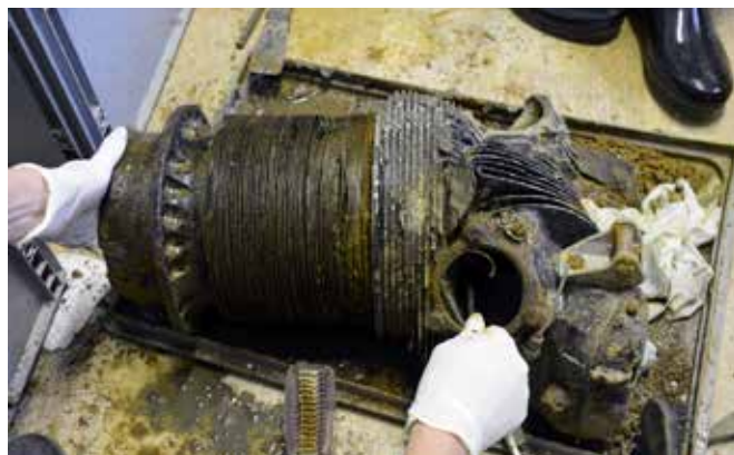
Tento snímek dokumentuje postup čištění nalezeného válce a ukazuje, že při odborně zdatném postupu lze i předměty, které jsou na první pohled silně poničeny korozi, uvést do téměř původního stavu. FOTO: Petr Čech
