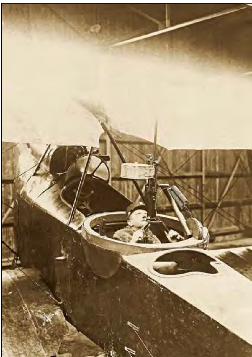
Prieselův oběžný kruh s kulometem Schwarzlose na Brandenburg C.I při zkouškách ve Fliegerarsenal . Ke kompenzaci hmotnosti zbraně byly použity dvě ocelové pružiny. Pokud se zbraň nepoužívala, byla ukryta ve výrezu v zadní části trupu.
