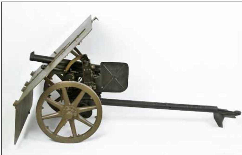
Rakousko-uherský modernizovaný 37mm pěchotní kanon vzor 16 ze sbírky VHÚ Praha.
