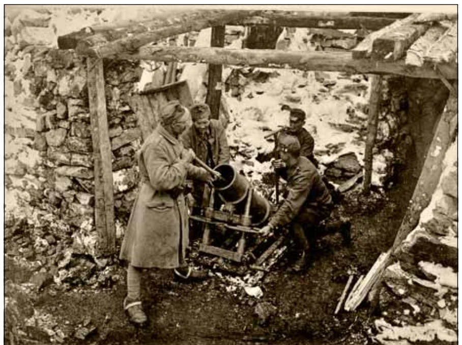
Rakousko-uherský 225mm minomet vz. 15 Böhler v palebném postavení na italské frontě. Tato zbraň patřila mezi jedny z nejlepších zákopových palebných prostředků vhodných k postřelování nepřátelských zákopů a k ničení ostatních drátěných zátarasů. Za války bylo vyrobeno více než tisíc kusů.
