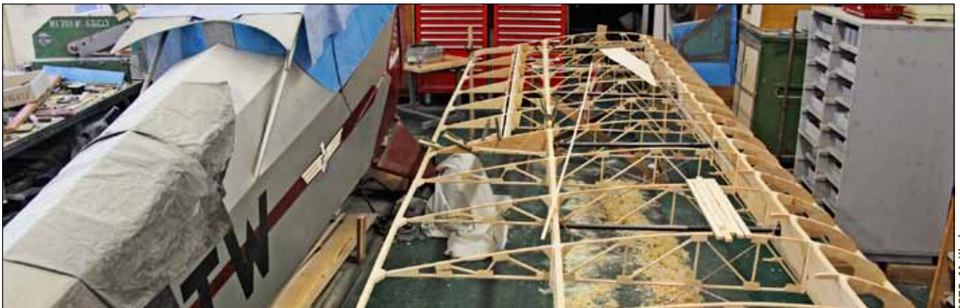
Konstrukce levé poloviny křídla Tayloru E-2 v dílně muzea před dokončením.
