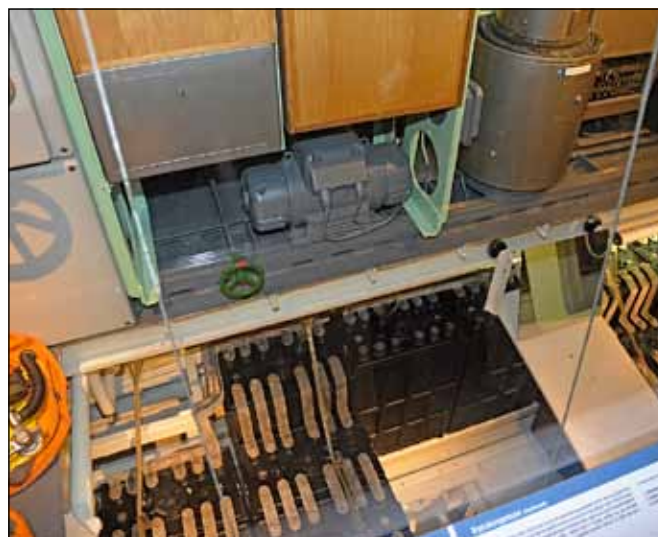
Právě díky bateriím na snímku mohla být ponorka ponořena mnoho hodin pod hladinou oceánů.
